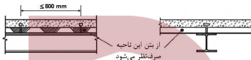
شکل ۸-۲-۱۰-ا: عرشه فولادی که کنگره‌های آن عمود بر محور طولی تیر است
